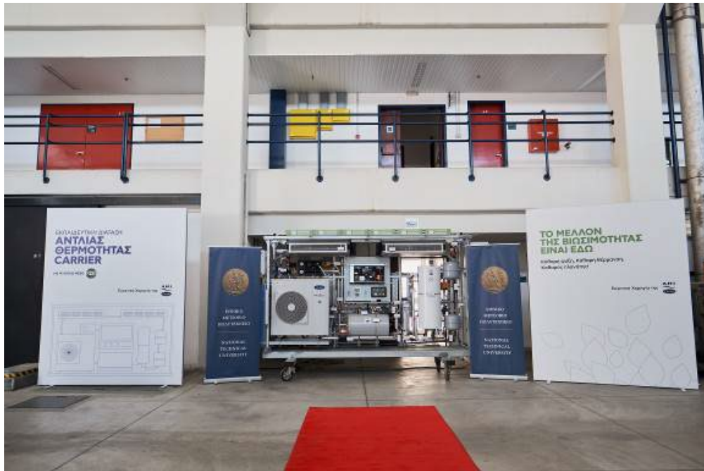
Πλήρως εξοπλισμένη εκπαιδευτική διάταξη αντλίας θερμότητας Carrier με ψυκτικό μέσο R-290.
