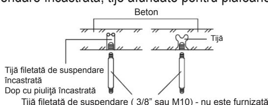
2.2.3 Instalați tijele filetate de suspendare (utilizați tije filetate W3/8 sau M10, 4 bucăți), în funcție de tipul de plafon.
