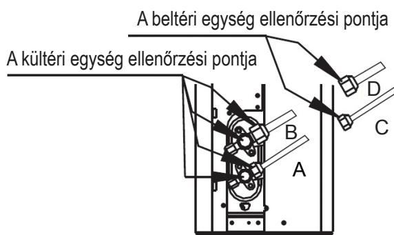
A: Kisnyomású zárószelep
