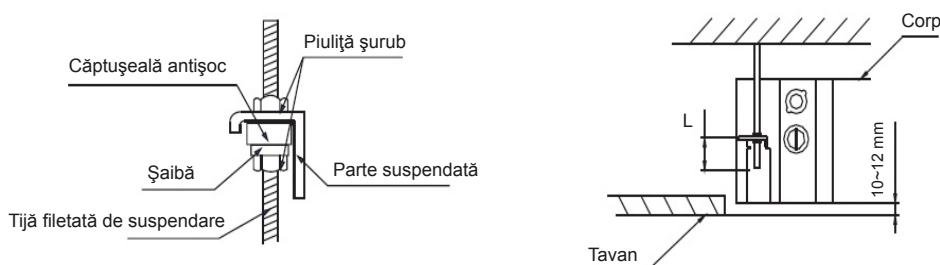
2.3.3 Strângeți piulițele pentru a suspenda unitatea. Verificați partea inferioară a unității interioare. Aceasta trebuie să intre în tavan pe o distanță de 10-12 mm. L este aproximativ jumătate din lungimea întreagă a cârligului de instalare.
