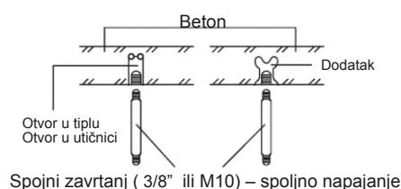
2.2.3 Ugradite spojne zavrtnje (koristite spojne zavrtnje tipa W3/8 ili M10, 4 komada) zavisno od vrste plafona.
