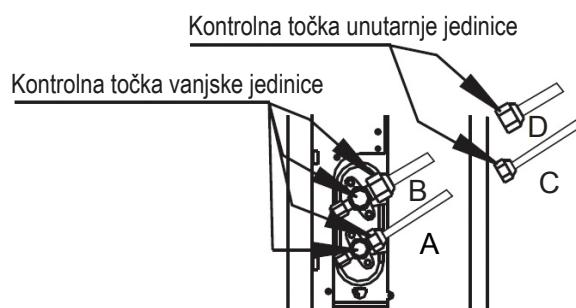
A: Niskotlačni zaporni ventil
