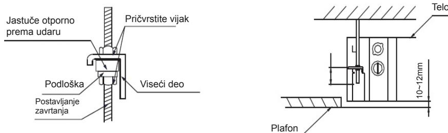
2.3.3 Pričvrstite vijke da biste okačili jedinicu. Uverite se da li je donja strana unutrašnje jedinice locirana na poziciji (10 do 12 mm) višoj od donje površine plafona. Lje dužine oko polovine zavrtnja na kuki za ugradnju.
