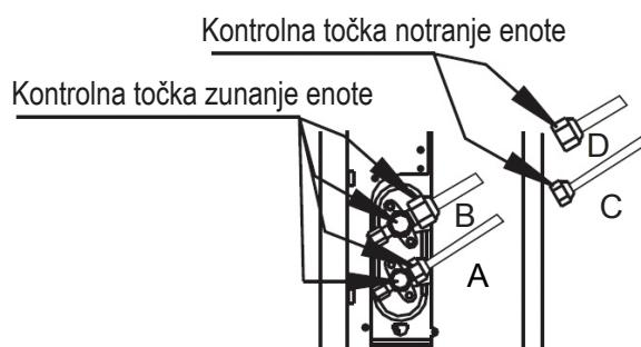
A: Nizkotlačni zaporni ventil
