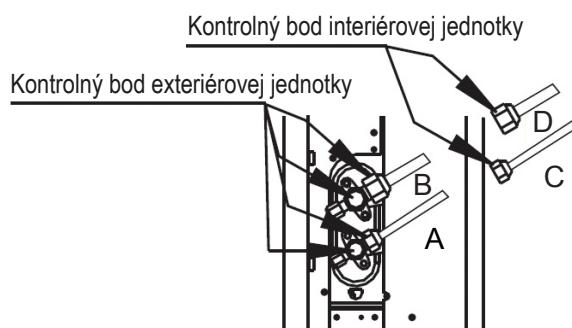
A: Nízkotlakový uzatvárací ventil
