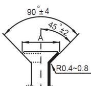
4.1.4 Verificați dacă evazarea a fost efectuată în mod corespunzător. Mai jos sunt câteva exemple de țevi incorrect evazate.
