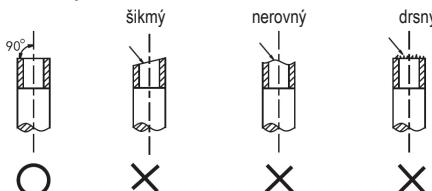
4.1.2 Pomocou výstružníka odstraňte otrepky so zrezanou plochou smerom dole tak, aby odrezky nevstupovali do potrubia.
