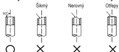
4.1.2 Použijte výstružník k odstranění otřepů z odříznutého povrchu tak, aby se úlomky nedostaly do trubky.
