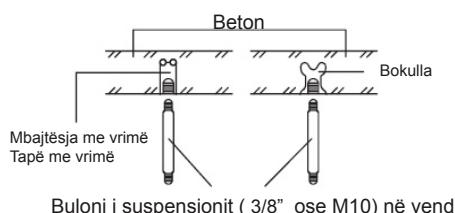
2.2.3 Instaloni bulonat e suspensionit (përdorni bulona suspensi W3/8 ose M10, 4 copë) në varësi të llojit të tavanit.
