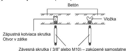
2.2.3 Nainštalujte závesné skrutky (použitie závesné skrutky W3/8 alebo M10, 4 kusy), v závislosti od typu stropu.
