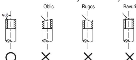
4.1.2 Utilizați un lărgitor pentru a elimina bavurile de pe suprafața tăiată îndreptată în jos, astfel încât așchiile să nu cadă în țeavă.
